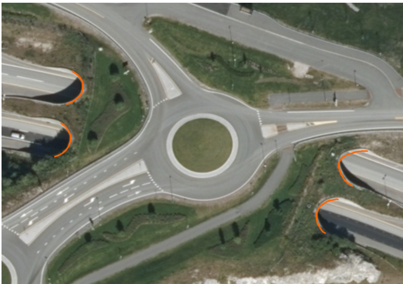
Figur 13. Illustrasjon av objekttype Tunnelportal
