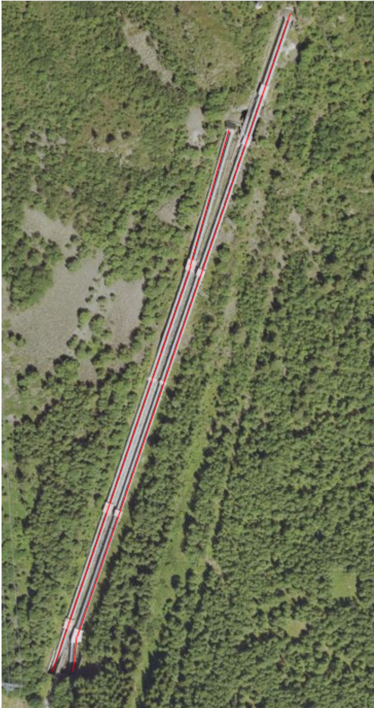
Figur 66. Illustrasjon av objekttype Rørgate
